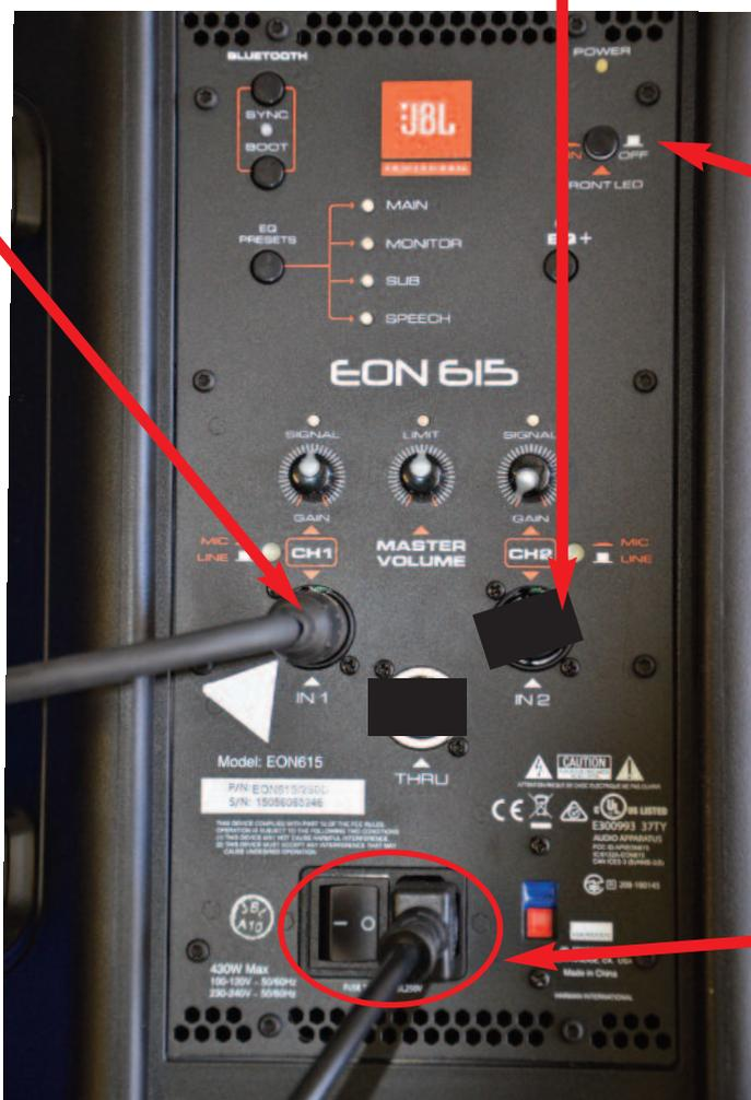
Ce bouton en position enfoncée permet de contrôler, grâce à une LED qui s'allume en bas sur le devant des hauts-parleurs, si ceux-ci sont bien allumés.
