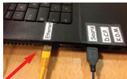
1.10 Brancher la prise d'alimentation de l'ordinateur sur la prise multiple déjà utilisée. Brancher le câble réseau jaune (rangé dans la sacoche de l'ordinateur) entre la prise ethernet de l'ordinateur et celle du routeur Linksys (triangle jaune sur celui-ci).
